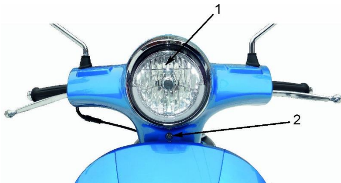
Рисунок 18 – Расположение винта для регулировки ближнего света фары
