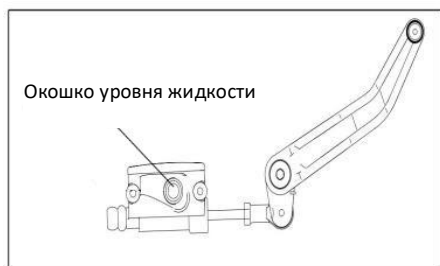
Рисунок 30 Проверка уровня тормозной жидкости заднего тормоза
