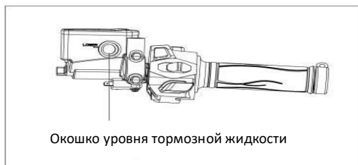
Рисунок 25 Проверка уровня тормозной жидкости переднего тормоза
